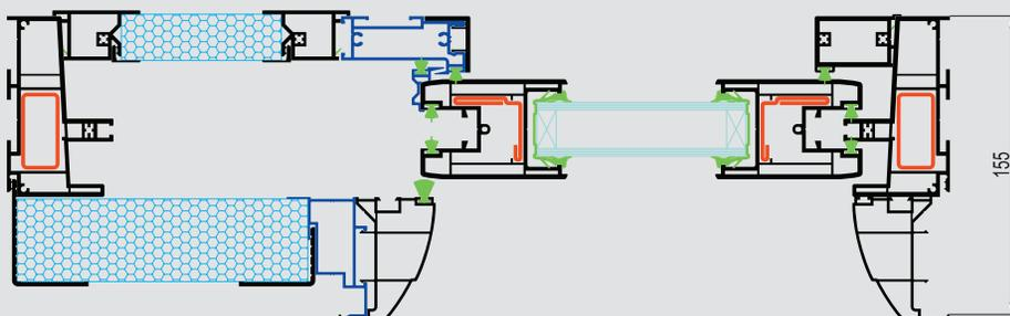
*Il allie design, avec une symétrie parfaite entre la partie refoulement et la partie crémone et une simplicité de mise en œuvre (structure d'isolation intégrée sur le couissant).*
